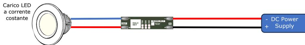
Figura 6: Schema di collegamento all'alimentatore
